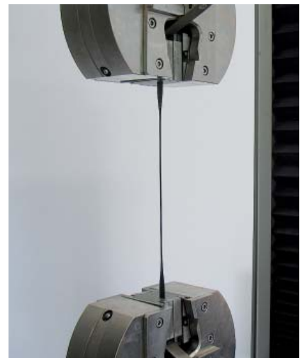
Abbildung 1: Prüfung der Reißfestigkeitsprüfung im DLG Testzentrum
