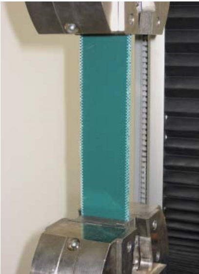
Bild 2: Prüfung der Reißfestigkeit im DLG Testzentrum
