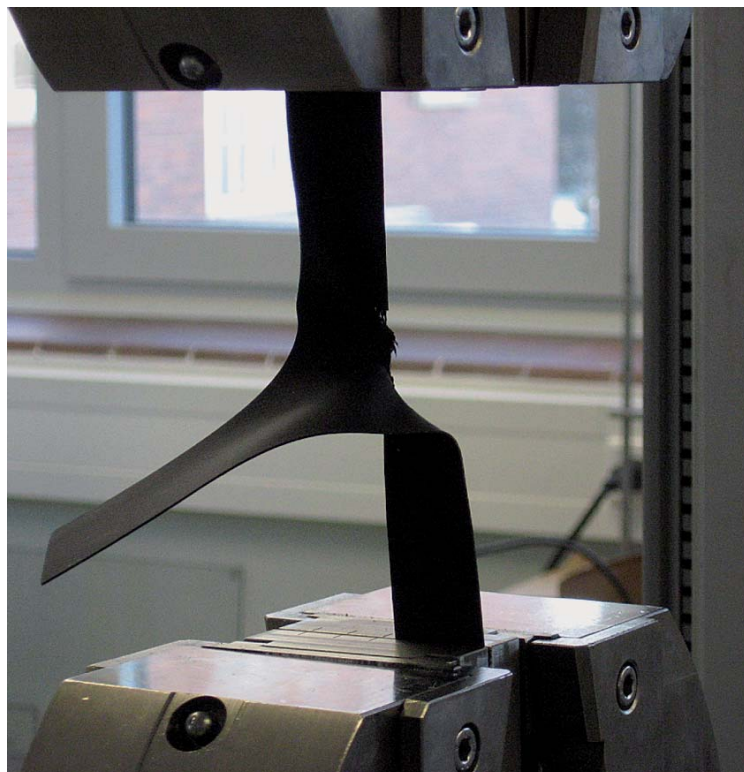
Bild 3: Prüfung der Weiterreißfestigkeit im DLG Testzentrum
